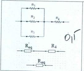
$$\begin{split} R_{eq} &= R'_{eq} + R_3 \\ R_1, R_2 \text{ et } R_3 \text{ en parallèle } \Rightarrow \frac{1}{R'_{eq}} = \frac{1}{R_1} + \frac{1}{R_2} + \frac{1}{R_3} \\ &\Rightarrow \frac{1}{R'_{eq}} = \frac{R_2 R_3 + R_1 R_3 + R_1 R_2}{R_1 R_2 R_3} \\ &\Rightarrow R'_{eq} = \frac{R_1 R_2 R_3}{R_2 R_3 + R_1 R_3 + R_1 R_2} \\ R'_{eq} \text{ et } R_4 \text{ en série } \Rightarrow R_{eq} = \frac{R_1 R_2 R_3}{R_2 R_3 + R_1 R_3 + R_1 R_2} + R_4 \text{ } (\Omega) \end{split}$$
