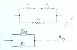
$$\begin{split} R_{eq} &= R'_{eq} + R_3 \\ R_1 et \ R_2 \ \text{en s\'erie} \ \Rightarrow R'_{eq} = R_1 + R_2 \\ R'_{eq} et \ R_3 \ \text{en parall\`ele} \ \Rightarrow \frac{1}{R_{eq}} = \frac{1}{R'_{eq}} + \frac{1}{R_3} = \frac{R'_{eq} + R_3}{R'_{eq} R_3} \\ \Rightarrow R_{eq} = \frac{(R_1 + R_2)R_3}{R_1 + R_2 + R_3} \ (\Omega) \end{split}$$
