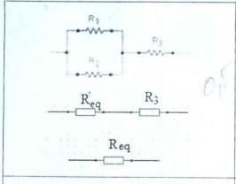
$$\begin{split} R_{eq} &= R'_{eq} + R_3 \\ R_1 et \, R_2 \text{ en parallèle} \ \Rightarrow \frac{1}{R'_{eq}} = \frac{1}{R_1} + \frac{1}{R_2} = \frac{R_1 + R_2}{R_1 R_2} \\ \ \Rightarrow R'_{eq} &= \frac{R_1 R_2}{R_1 + R_2} \end{split}$$
